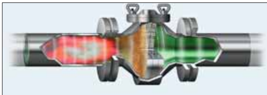
Figura 33: dispositivo di arresto di fiamma contro le esplosioni [1].
