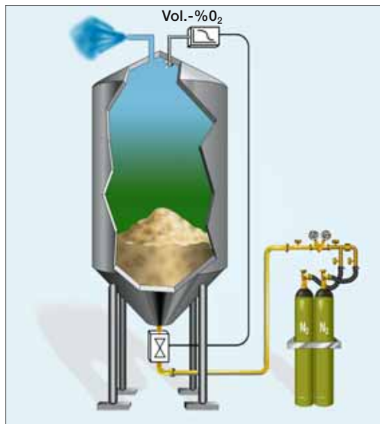
Figura 31: inertizzazione con l'aggiunta di azoto e monitoraggio della concentrazione di ossigeno [3]
