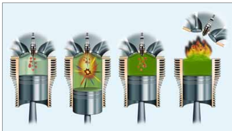
miscela troppo povera miscela esplosiva miscela troppo ricca (sistema chiuso) miscela troppo ricca (sistema aperto)
