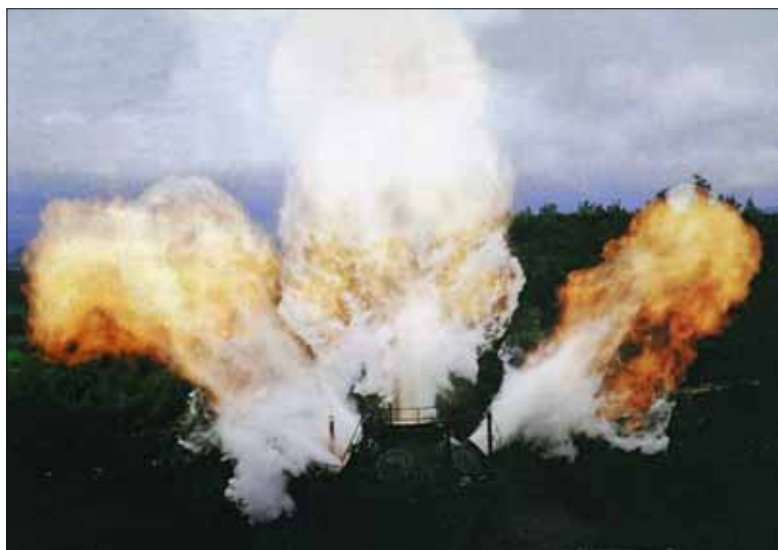
Figura 8: esplosione secondaria all'esterno del recipiente [5]
