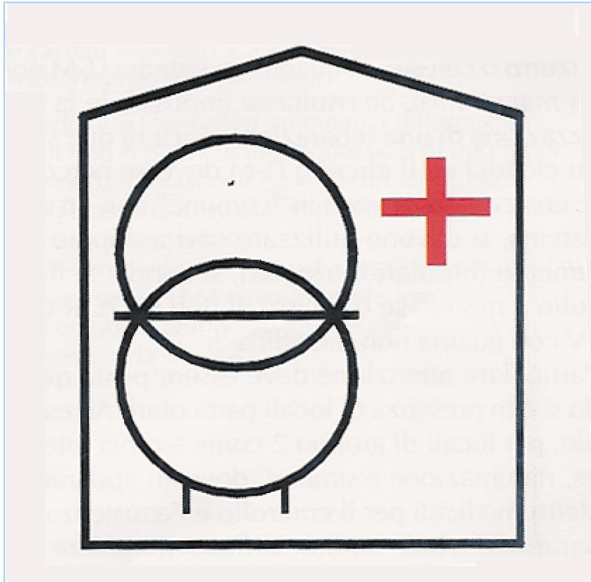
FIGURA 2: Logo del trasformatore d'isolamento di tipo medicale
