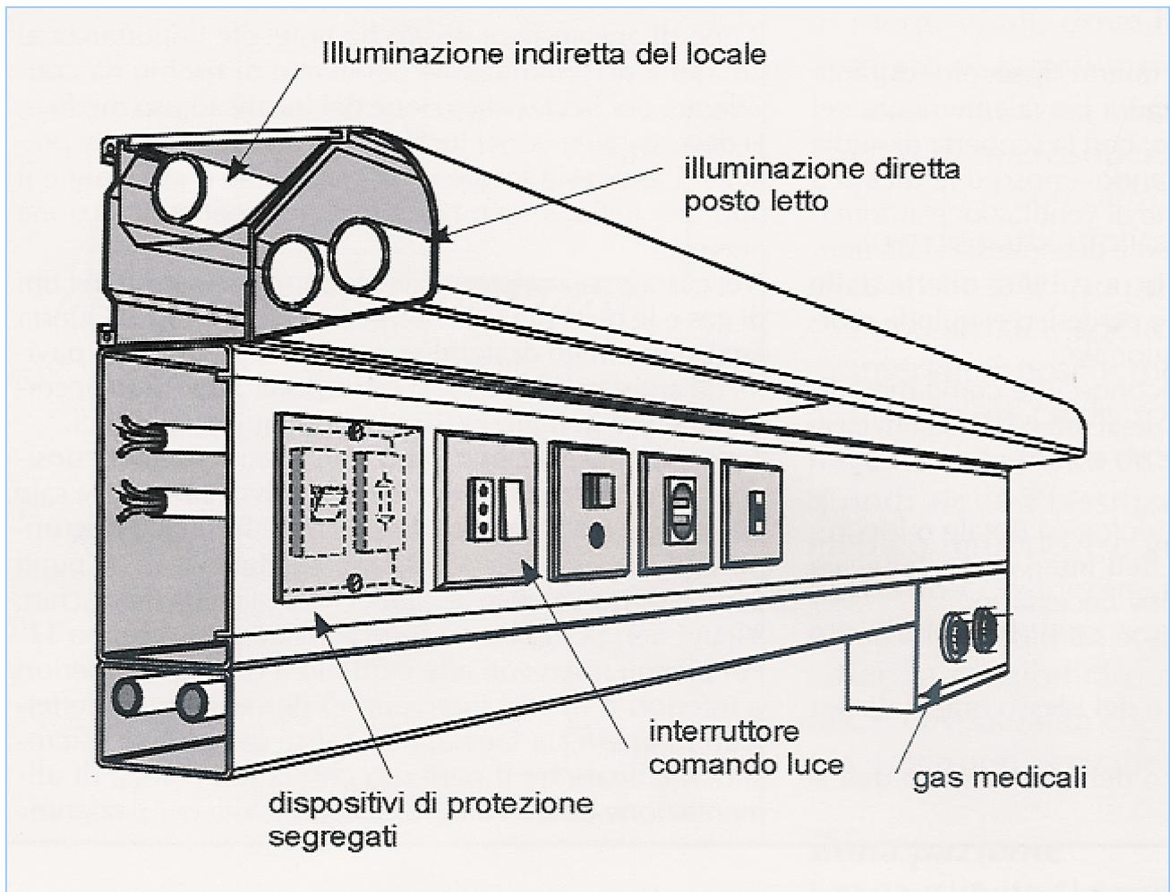
FIGURE 3: Unità di alimentazione ad uso medico (esempio testaletto). Secondo la Norma UNI EN 793 non devono esistere interruttori o fusibili a portata di mano a protezione delle prese. Se esistono delle prese sull'unità di alimentazione, le protezioni devono essere accessibili solo utilizzando una protezione meccanica(coperchio) apribile solo con attrezzo.
