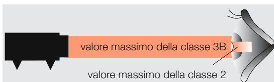
Per l'intero raggio è ammessa una potenza irradiata fino a 0,5 watt (= valore limite per la classe 3B). Il raggio viene tuttavia limitato dalla pupilla in modo tale che la retina può essere colpita al massimo da 1mW di potenza irradiata.
