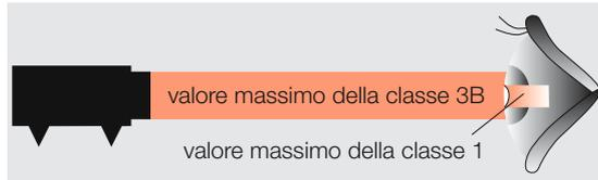
Per l'intero raggio è ammessa una potenza irradiata fino a 0,5 watt (= valore limite per la classe 3B). Nel campo di lunghezza d'onda da 400nm a 1400 nm il raggio viene limitato dalla pupilla. Di conseguenza, solo una parte del raggio, che non supera il valore limite della classe 1, raggiunge la cavità oculare. La pupilla rende quindi inoffensivo il raggio laser. Per le altre lunghezze: d'onda consultare la norma sui laser.
